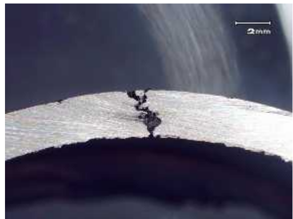
Gambar 5. Permukaan pipa AISI 316L yang mengalami kebocoran
