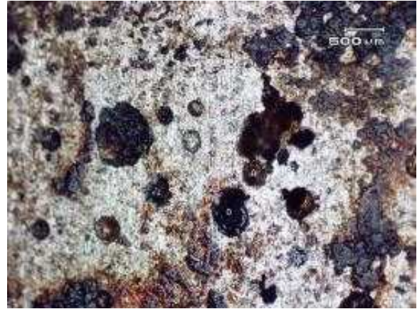
Gambar 5. Permukaan pipa AISI 316L yang mengalami kebocoran
